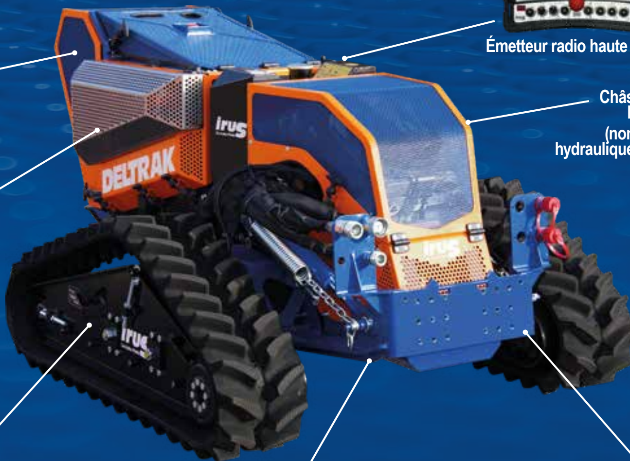
Changement rapide de la plaque d'ancrage pour la fixation de différents accessoires (Pages 29-40) Triangle d'attelage pour un changement d'appareil sans outil sur le terrain (en option)
