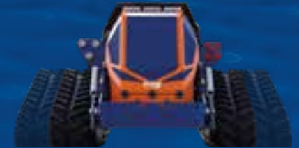
hydraulische Spurbreitenverstellung mit einzeln ausfahrbaren Fahrwerken (optional)
