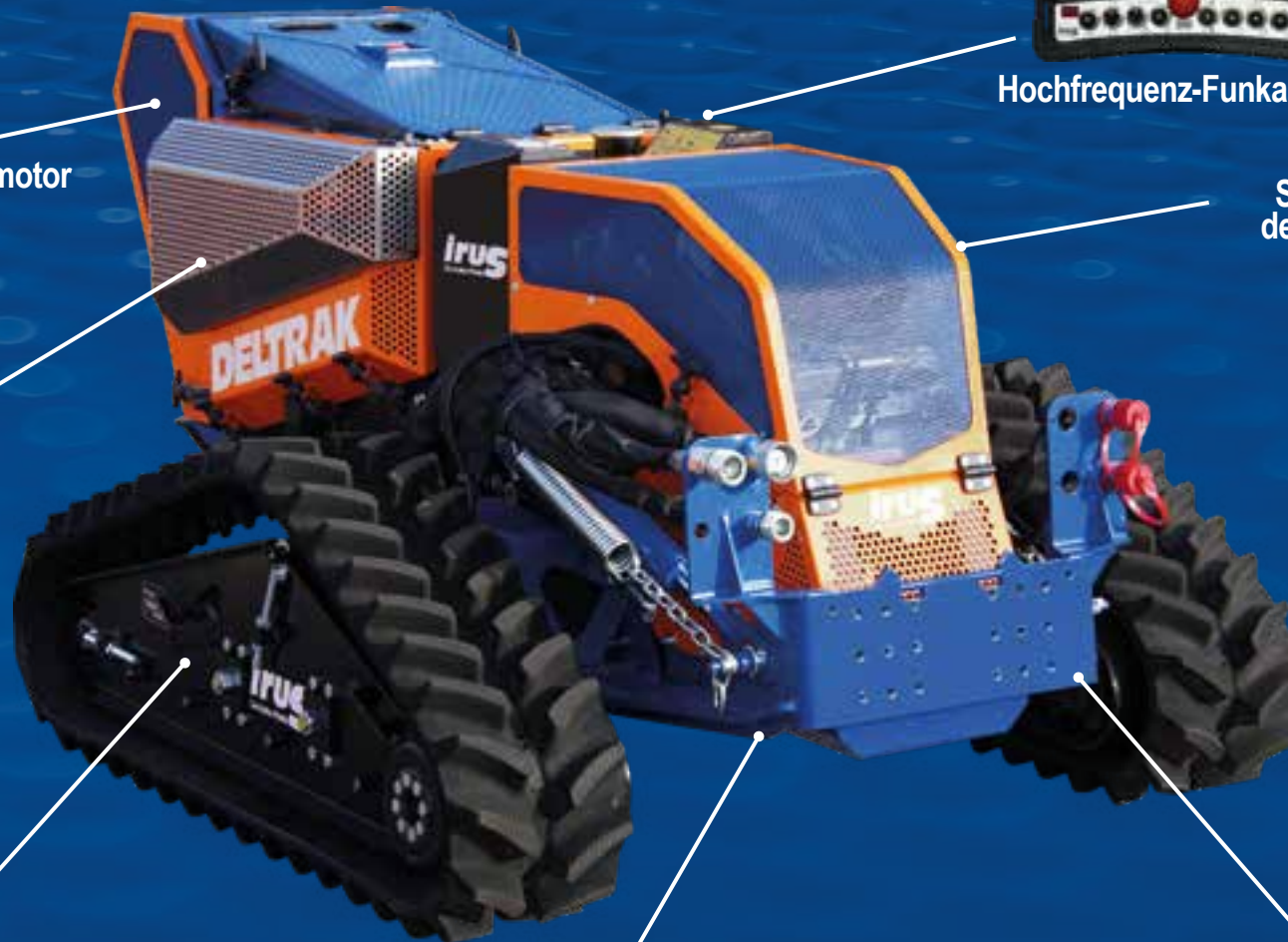
Schnellwechsel-Anbauplatte zur Aufnahme verschiedener Anbaugeräte (Seiten 29 - 40) Kuppeldreieck zum werkzeuglosen Gerätewechsel im Gelände (optional)
