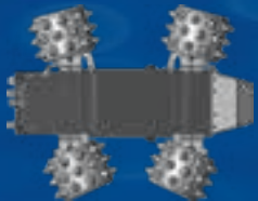
Allradlenkung Hundeganglenkung (optional)
